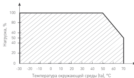
Рис. 2. Максимальная допустимая нагрузка, % от мощности источника.
