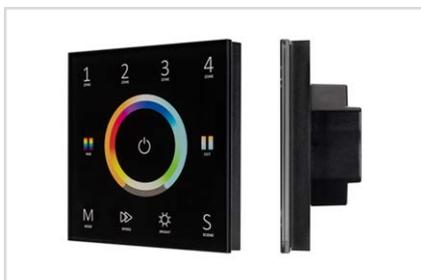
Встраиваемая сенсорная панель 2.4 ГГц, цвет черный. Материал — стекло. Для управления RGB+MIX (5-канальными) источниками света (ШИМ), 4 зоны управления. Питание/рабочее напряжение AC 100–240 В. Функция управления устройствами DMX512. Габариты 86×86×35 мм. Панель совместима с контроллерами серии SMART.
