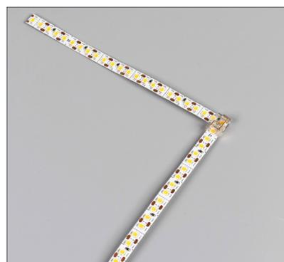
4. Т-ОБРАЗНОЕ СОЕДИНЕНИЕ ДВУХ ОТРЕЗКОВ ЛЕНТ
