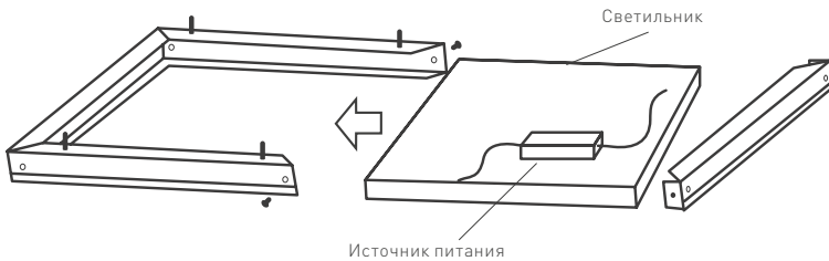
Рис. 2. Установка светильника в рамку.
