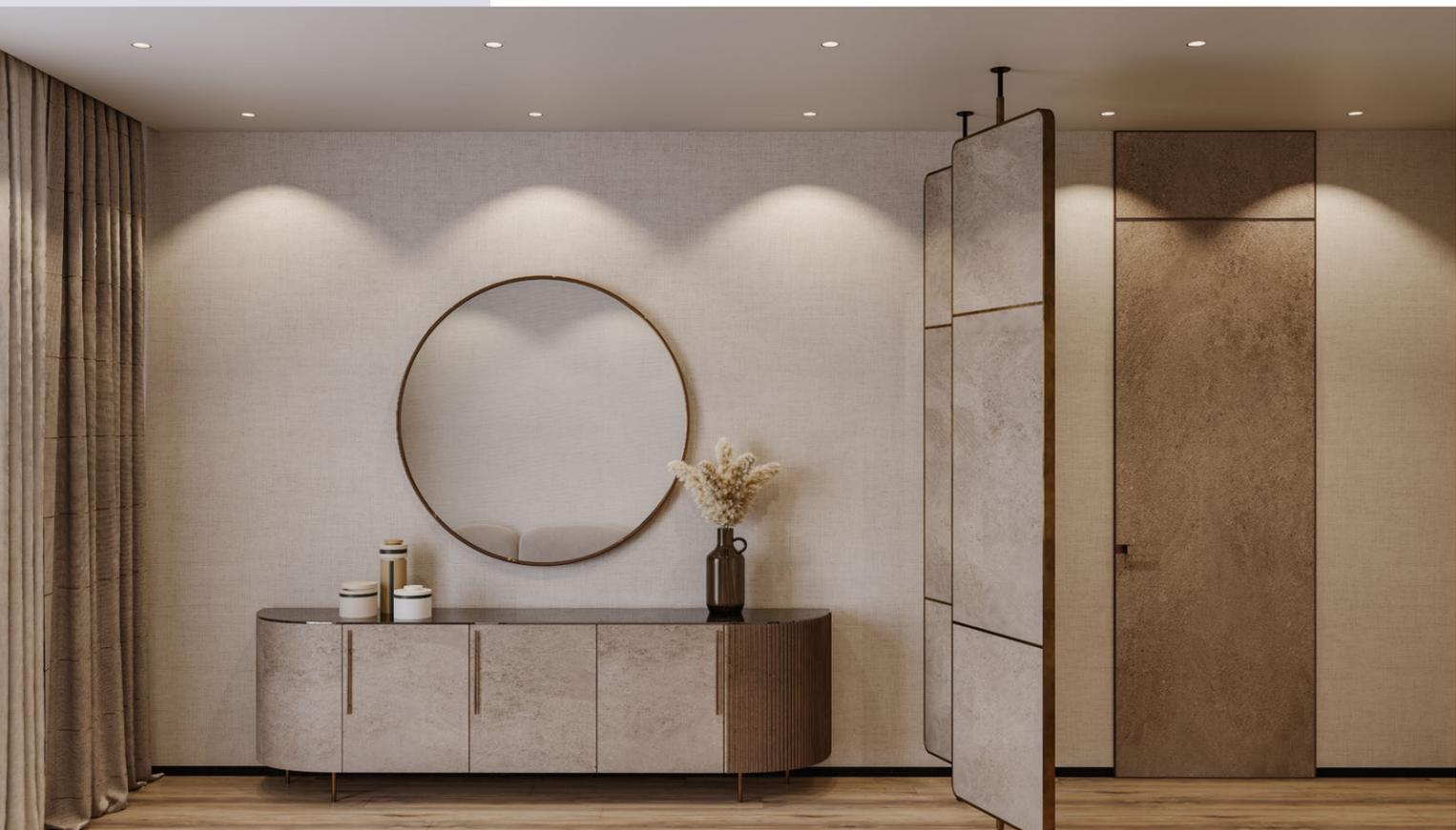
Светоизлучатель в безрамочных даунлайтах ATLAS TRIMLESS расположен глубоко внутри корпуса, благодаря чему создается направленное свечение без слепящего эффекта. За счет конструктивных особенностей светильника на стенах холла образуется световой рисунок с мягкими округлыми очертаниями. Высокий индекс цветопередачи (CRI>90) позволяет в полной мере раскрыть теплую бежево-коричневую цветовую гамму интерьера, которая со всех сторон окутывает вошедшего в холл уютом и спокойствием.
