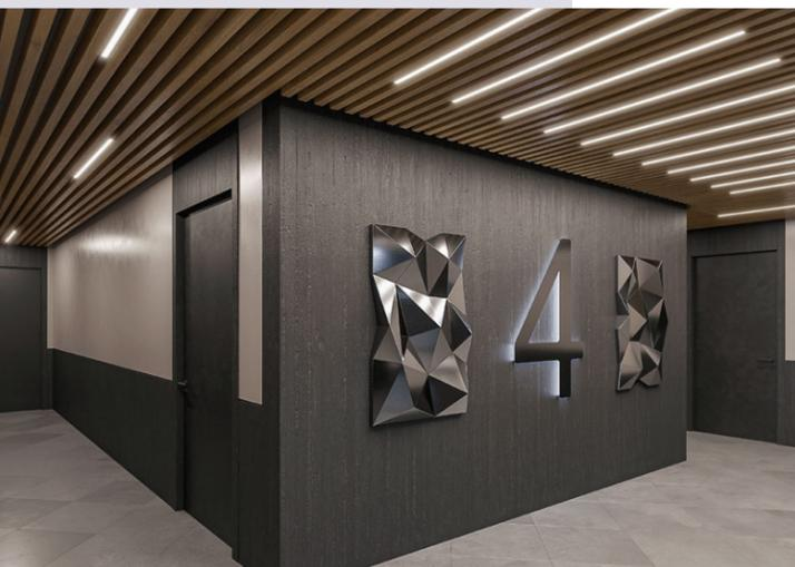
Дизайнерский потолок в гостинице декорирован деревянными рейками со встроенными линейными светильниками на базе алюминиевого профиля SL LINE. Помимо качественного основного освещения, в холле выполнена декоративная подсветка номера этажа при помощи экономичной светодиодной ленты малой мощности холодного цвета свечения.
