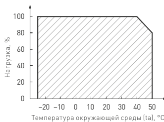
Рис. 6. Максимальная допустимая нагрузка, % от мощности источника
