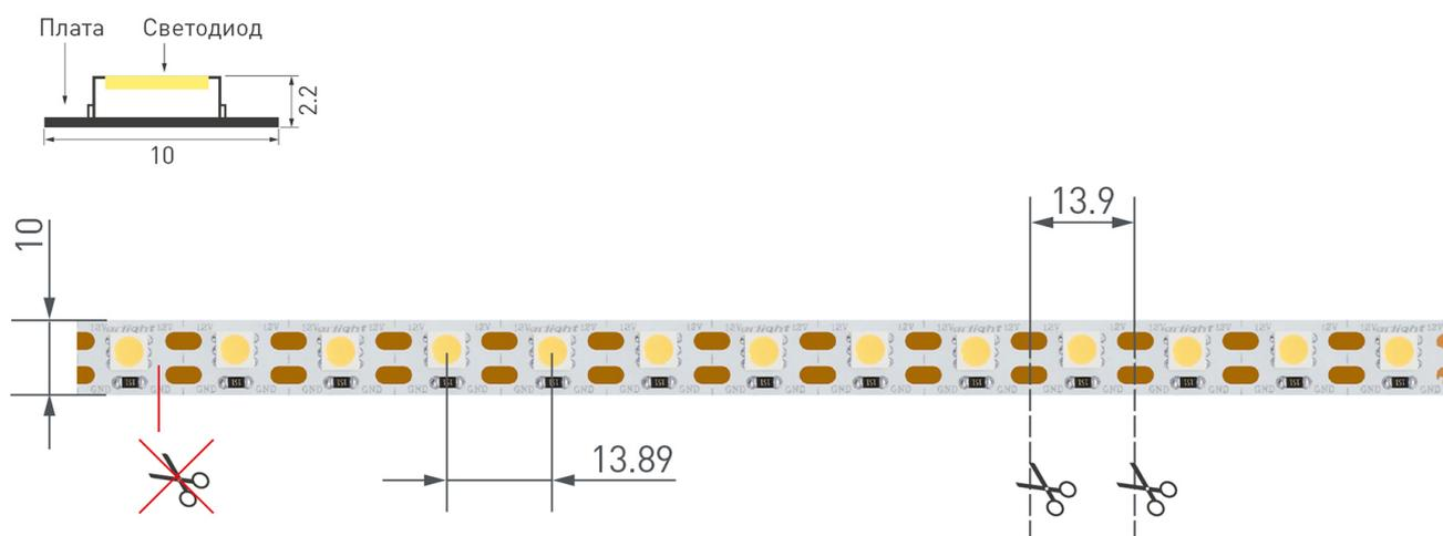
Не допускается разрезать ленту в необозначенном месте.
