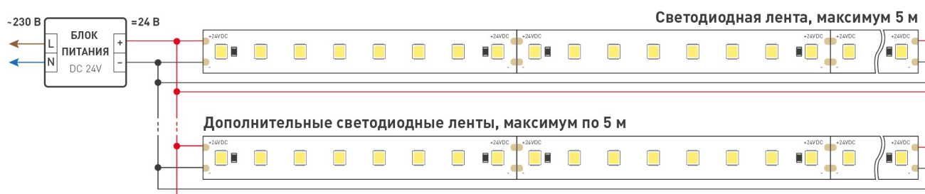
Схема 2. Подключение нескольких светодиодных лент с двух сторон.
