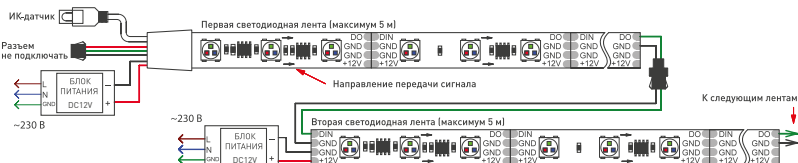
Рис. 1. Схема подключения ленты без использования внешнего контроллера (на примере лент с негерметичными разъемами)
